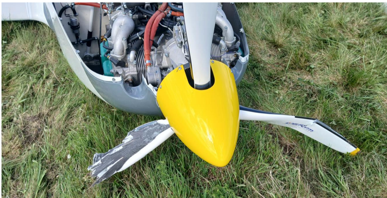
Obr. č. 3 poškodenie vrtuľovej jednotky
