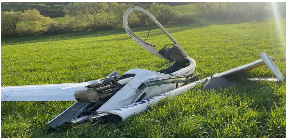
Obr. č. 5 detail na oddelené prechodovú rúru trupu a motor
