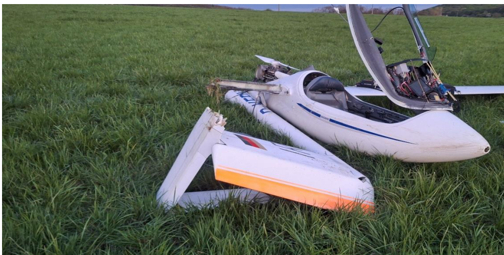
Obr. č. 6 detail na odlomenú pravú polovicu horizontálneho stabilizátora
