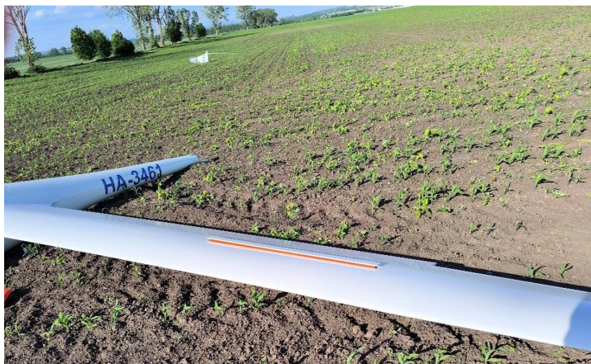
Obr. č. 6 vzájomná poloha vetroňa a oddelenej chvostovej časti
