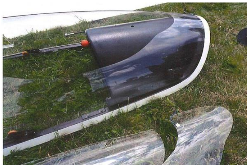
Obr. č. 10 prekryt s vylomenými časťami organického skla
