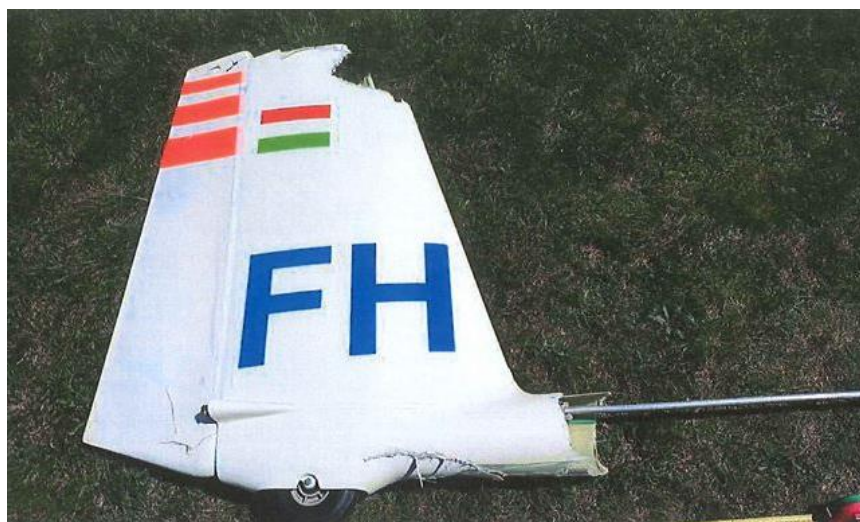
Obr. č. 13 poškodenia vertikálneho stabilizátora smerového kormidla
