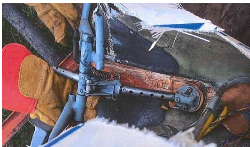
Obr. č. 11 uzol smerového riadenia
