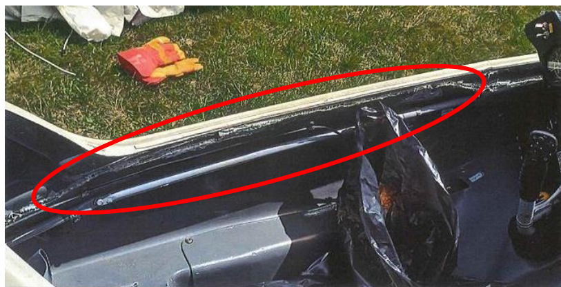
Obr. č. 12 detail poškodenia vnútorného obloženia vytrhnutím bowdenov ovládania smerového riadenia - ľavá strana
