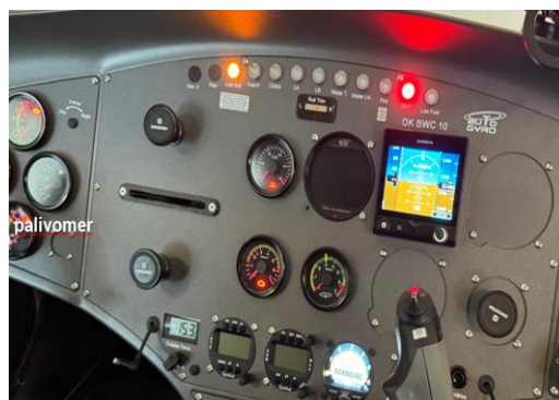
Obr. č. 2 konfigurácia pôvodnej palubnej dosky
