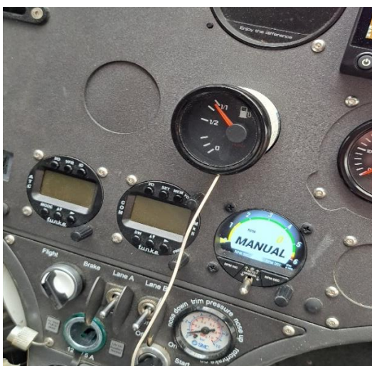
Obr. č. 14 ukazateľ paliva-plavák vo vrchnej polohe
