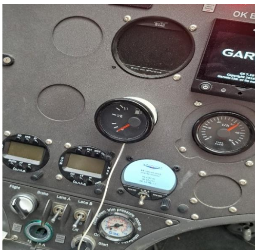
Obr. č. 13 ukazateľ paliva-plavák v spodnej polohe
