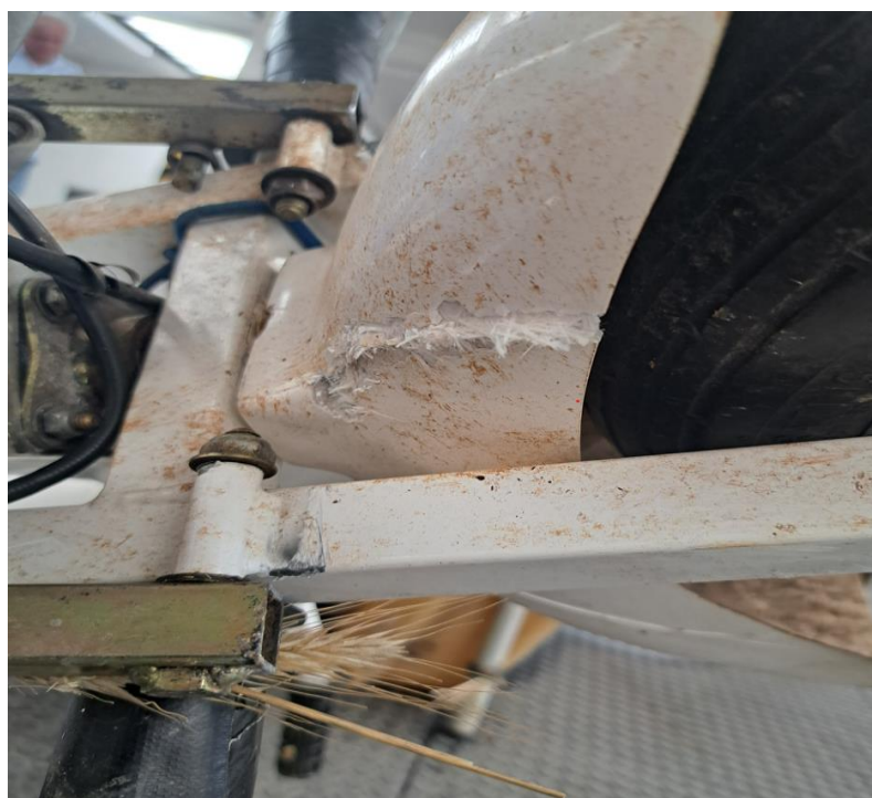
Obr. č. 2 miesto dotyku vodiča vysokého napätia s konštrukciou motorového rogala
