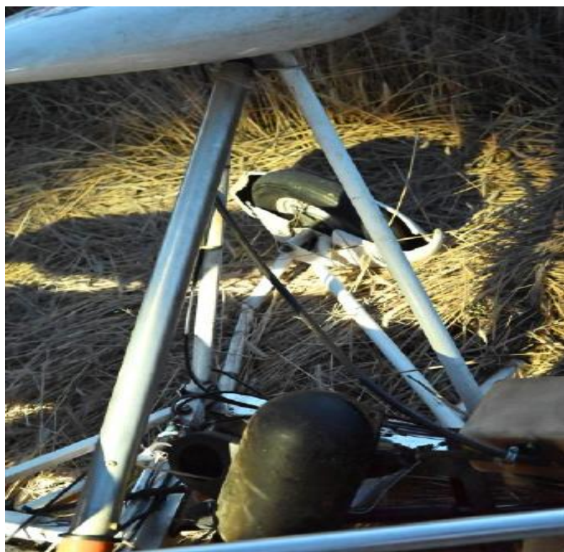
Obr. č. 4 poškodenie konštrukcie a pristávacieho zariadenia motorového rogalu
