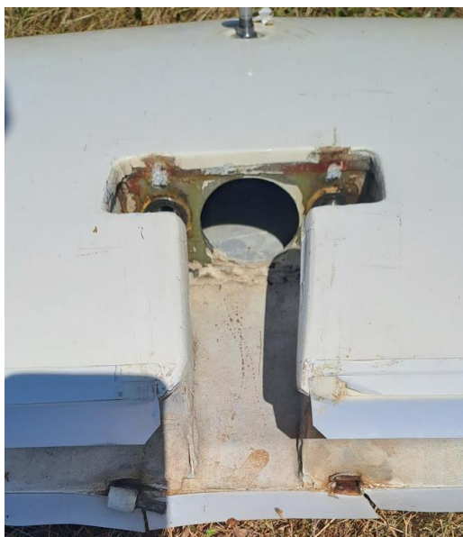
Obr. č. 2 detail na poškodený stabilizátor vodorovnej chvostovej plochy
