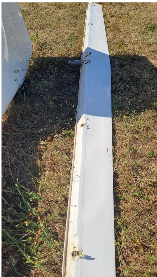
Obr. č. 3 deformácia/poškodenie výškového kormidla
