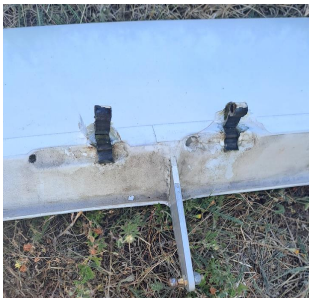
Obr. č. 1 poškodenie stabilizátora vodorovnej chvostovej plochy
