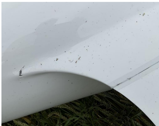
Obr. č. 5 poškodenie centroplánu
