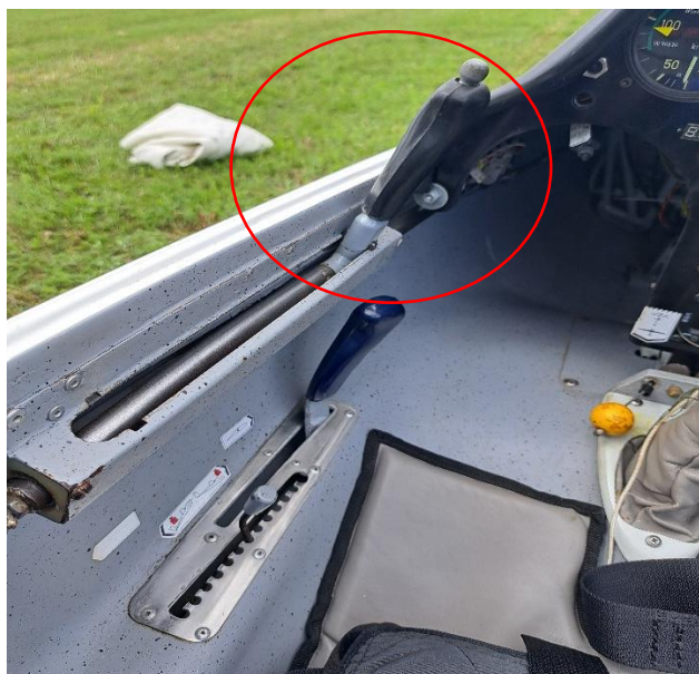
Obr. č. 5 detail na ovládacie prvky (zvýraznená páka ovládania podvozku)
