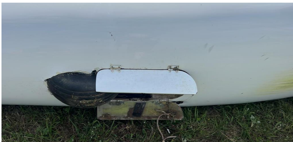
Obr. č. 3 poškodenie trupu a poloha kolesa
