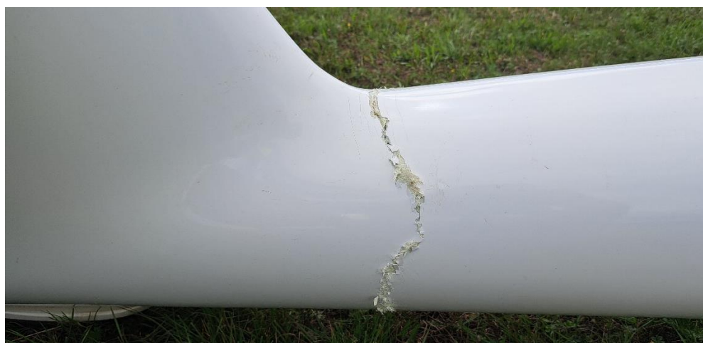
Obr. č. 4 prasklina predlžovacej rúry
